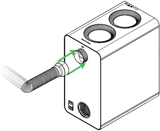
将连接好的接头和排烟管安装到净化器的进风口。
