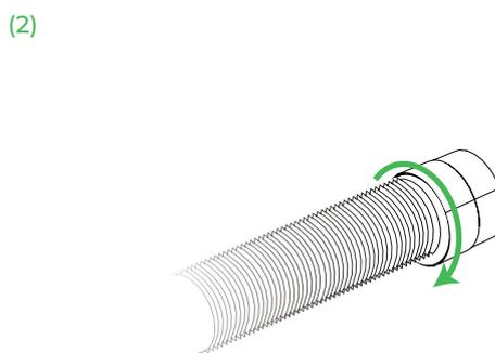
逆时针旋转接头, 确保烟管和接头连接牢固。
