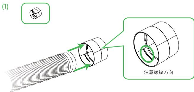
将包装随附的排烟管连接到排烟管接头 1。
