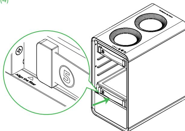
先将滤芯 5 装回。注意需要将滤芯推到底，能看到滤芯对齐线。
