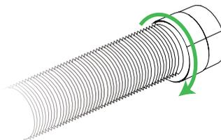
逆时针旋转接头, 确保烟管和接头连接牢固。
